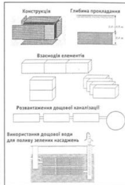
Рис. 3. Відведення дощових вод за допомогою лотків
