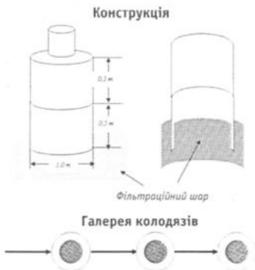
Рис. 5. Поглинальний колодязь AQUATRAIN
