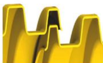
Łączenie komór na zakładkę
