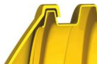
Montaż pokrywy skrajnej na zakładkę
