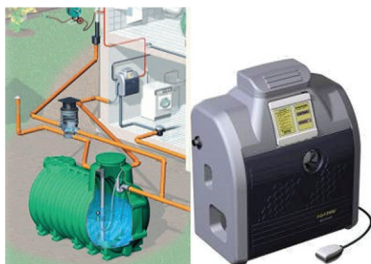
Rys. C.11. Typowa instalacja pozwalająca na wykorzystanie wody opadowej w domu od lewej: schemat ogólny, urządzenie pompowe obejmujące równocześnie bezpieczne przyłączenie uzupełniającej instalacji wody pitnej (np. materiałów firmy KESSEL)
