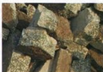
Fot. 7. Przetworzony beton, 20-50 mm 1)
