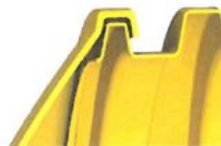
Montaż pokrywy skrajnej na zakładkę
